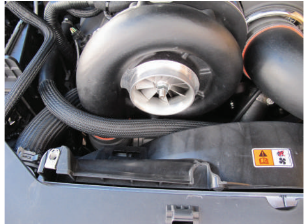
Fig. 10B-1: \text{Ø}\frac{3}{4} ” Coolant Hose
