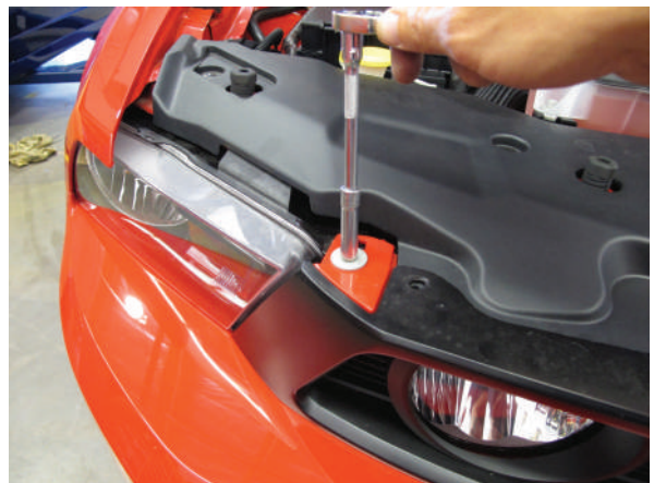
Fig. 12E-2: Top Edge Fasteners
