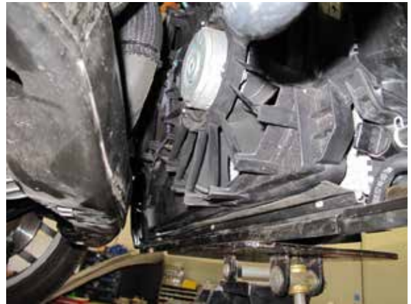
Fig. 2-s: Remove radiator fan assembly
