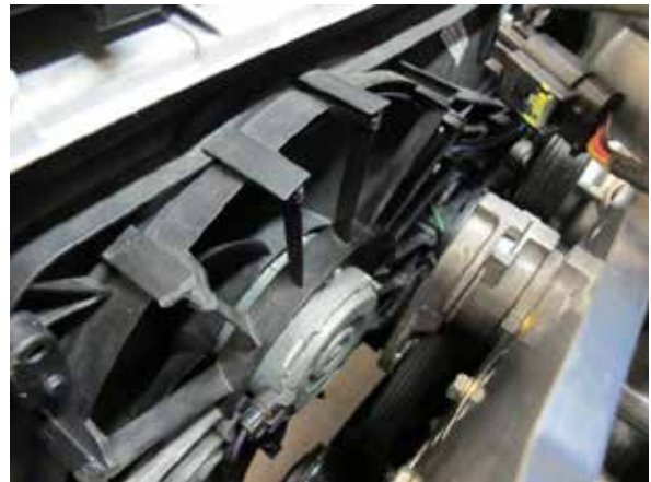
Fig. 2-n: Remove radiator fan assembly
