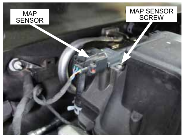
Fig. 10-i: Install 3-Bar MAP sensor
