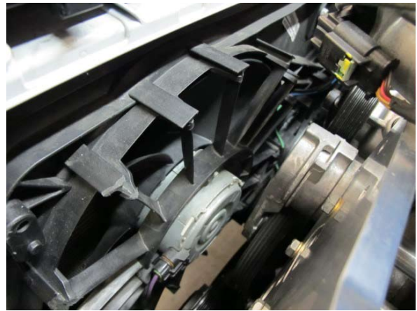
Fig. 2-n: Remove radiator fan assembly
