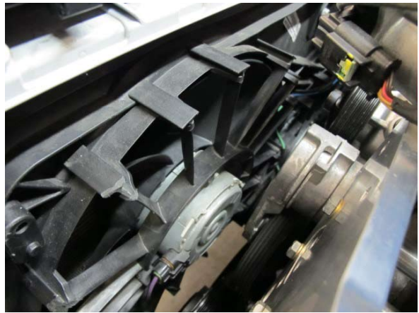
Fig. 4-b: Reinstall radiator fan assembly
