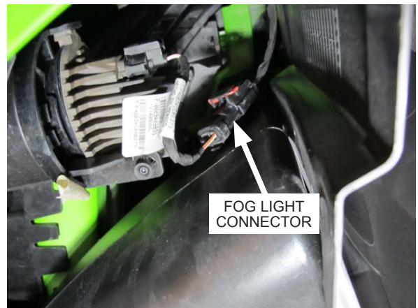
Fig. 2-e: Disconnect fog lights
