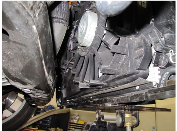
Fig. 2-s: Remove radiator fan assembly
