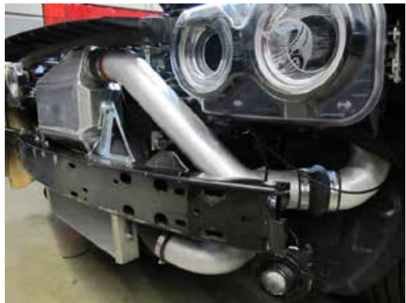
Fig. 7-ae: Install discharge tube 'B'
