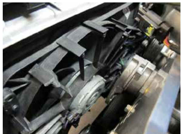
Fig. 2-r: Remove radiator fan assembly
