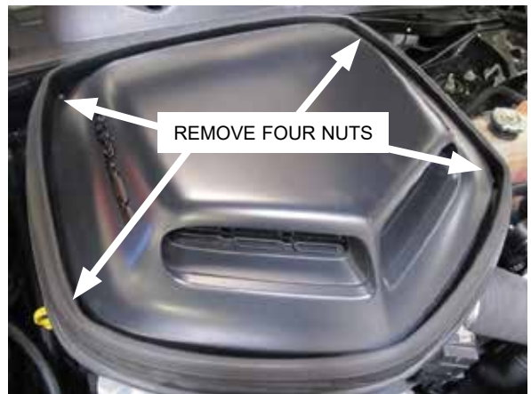
Fig. 2-n: Remove shaker scoop
