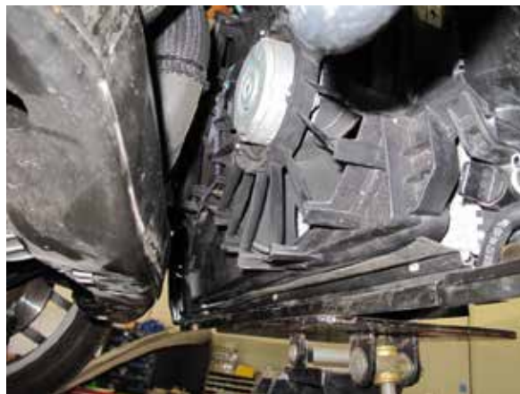
Fig. 2-w: Remove radiator fan assembly
