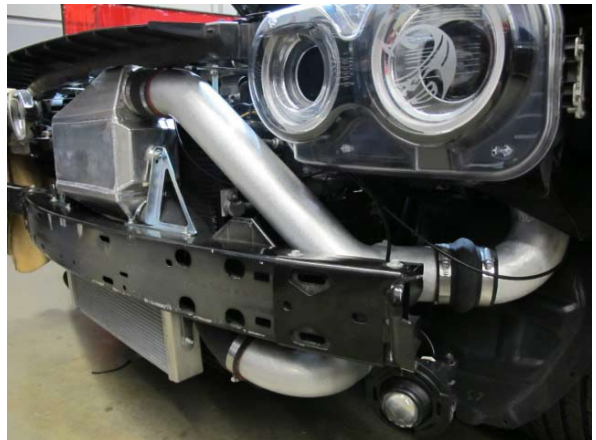
Fig. 7-ae: Install discharge tube 'B'
