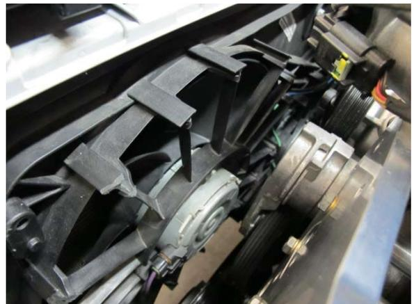
Fig. 2-r: Remove radiator fan assembly
