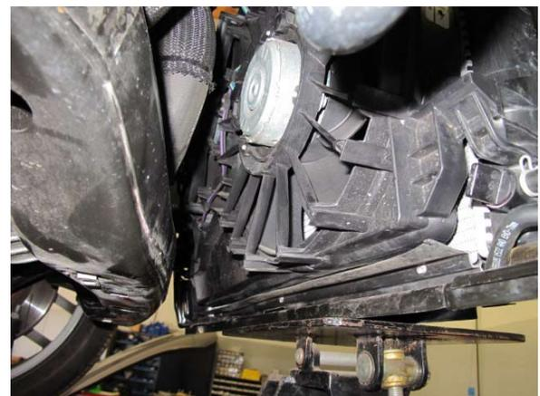
Fig. 2-x: Remove radiator fan assembly
