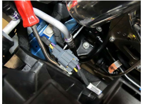
Fig. 4-m: Detach Cooling Fan Connector From Fan Shroud
