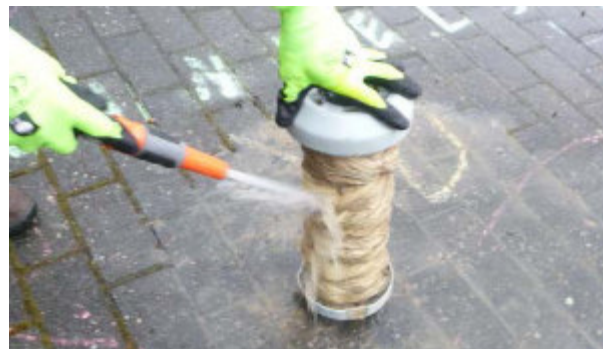
Spülen der Membranfasernbündel
