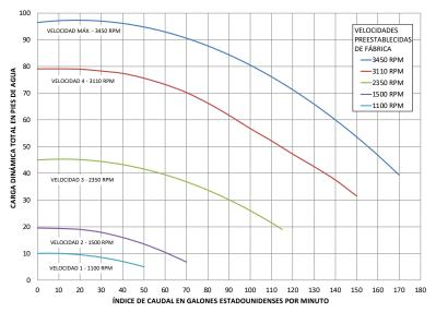
NOTA: La tabla de arriba muestra los índices de rendimiento a velocidades predeterminadas de fábrica de 3450 RPM, 3110 RPM, 2350 RPM, 1500 RPM y 1100 RPM.
