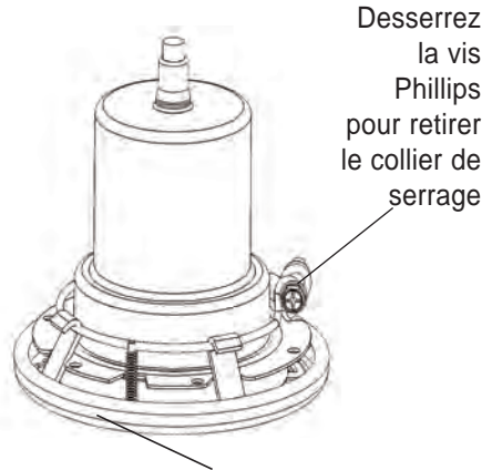
Appareil d'éclairage IntelliBrite blanc pour spa avec lentille, joint et anneau frontal fixés
