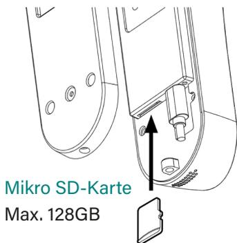
Wenn Sie eine SD-Karte zur automatischen Videoaufzeichnung installieren möchten, empfiehlt es sich diese bereits vor der Montage in das Gerät einzulegen. Der SD-Karten Steckplatz befindet sich unten auf der Rückseite des Geräts.
