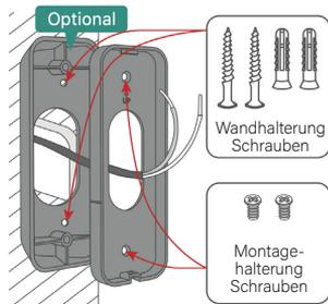
Markieren Sie die Bohrlöcher und bohren Sie die Löcher an den markierten Stellen. Befestigen Sie nun die Montageplatte und den Montagewinkel (optional) mit den beigelegten Montageschrauben.
