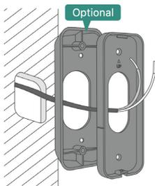
Platzieren Sie die Montageplatte und den Montagewinkel (optional) an den Montageort und führen Sie die vorhandenen Klingeldrähte durch das Loch in der Mitte der Montageplatte.
