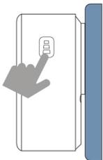
**Verbindungsmodus:** Halten Sie die Lautstärke-Taste für ca. 4 Sekunden gedrückt, bis die LED-Anzeige aufleuchtet.
