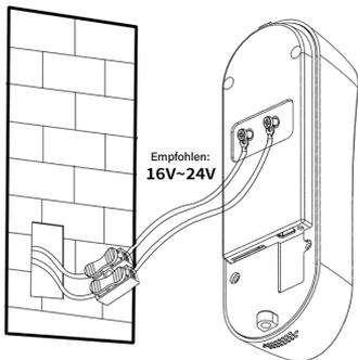
Verbinden Sie nun die vorhandenen Klingeldrähte (AC12-24V) mit den Kontaktstellen der Cardea, und befestigen Sie diese mit den beigelegten Schrauben.
