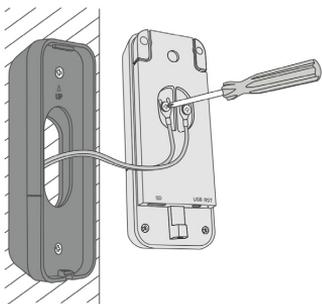
Verbinden Sie die Klemmschuhe des Stromkabels mit den mitgelieferten Schrauben an der Video Türklingel.
