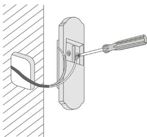
Schalten sie vor der Verbindung den Hauptstromschalter (Sicherung) aus!
