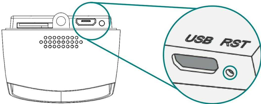
Nehmen Sie die beigelegte Reset-Nadel und drücken Sie die Reset-Taste (siehe Abbildung) vorsichtig für ca. 5-8 Sekunden ein. Nachdem die Video Türklingel erfolgreich in den Werkzustand zurückgesetzt wurde, ertönt eine Signal-Melodie. Die LED-Anzeige blinkt nach dem Zurücksetzen rot.
