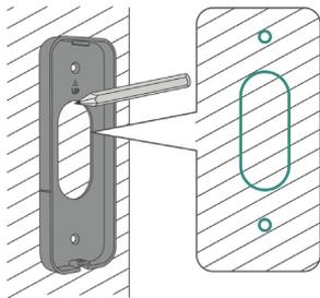
Halten Sie die Montageplatte an den Montageort und markieren Sie die Bohrlöcher mit einem Stift.
