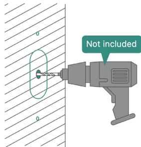
Bohren Sie die Löcher für die Montageplatte an den markierten Stellen. Bohren Sie ein weiteres Loch in der Mitte der Montageplatte um das Stromkabel von Innen durchzuführen.
