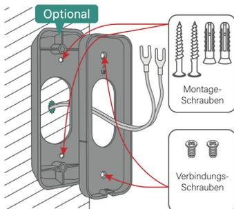
Führen Sie das Stromkabel von Innen durch das mittig gebohrte Loch und durch die Montageplatte und Winkel (optional). Befestigen Sie nun die Montageplatte und Winkel (optional) an der Wand.
