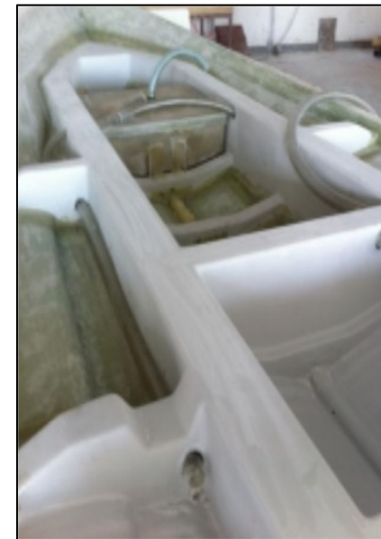
Struttura interna longitudinale e trasversale
