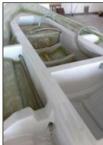
Struttura interna longitudinale e trasversale
