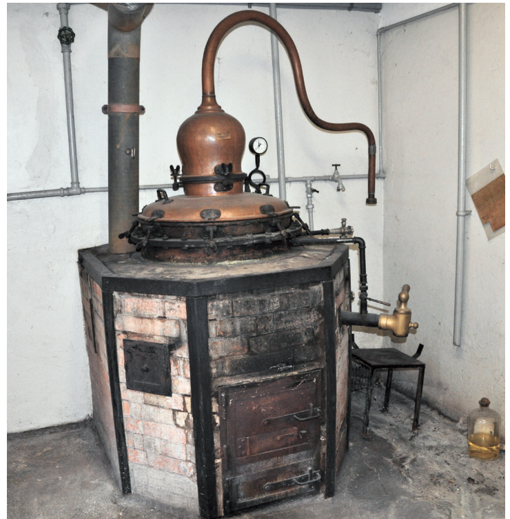
Unten: Destillationsanlage zur Extrahierung der Kräuter im Keller der Villa Salve.
