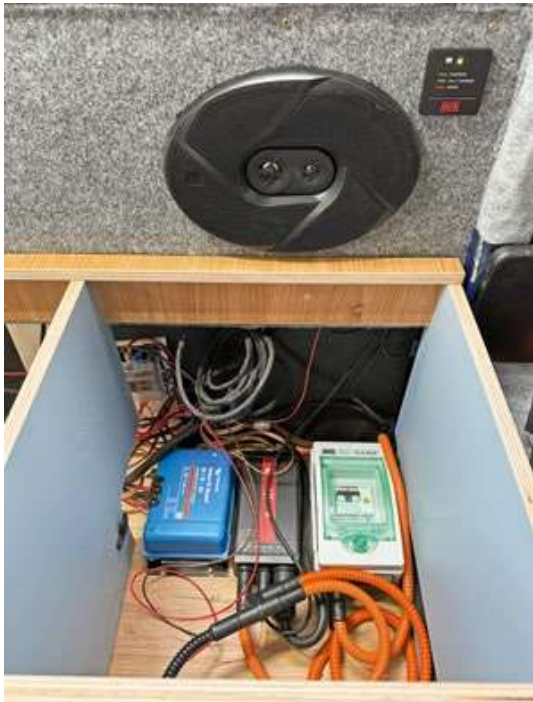
Ladegerät, Ladebooster und FI sind unter dem doppelten Boden in der Sitzruhe verstaut.
