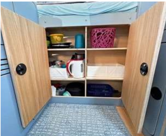
Im vorderen Teil des Stauraums sind Teller, Töpfe, Tassen und Vorräte untergebracht. Der Platzbedarf wurde vorher ermittelt, die Breite des Bettes ist Auer-Box plus Küchenbedarf.
