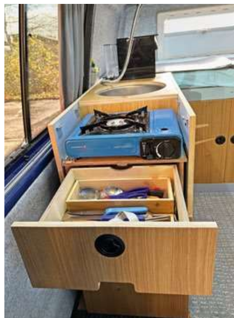
Bei gutem Wetter – Zweiflammkocher: Einmal Gas, einmal Spiritus. Für mehr Arbeitsfläche kann der Kocher samt Schublade herausgezogen werden.
