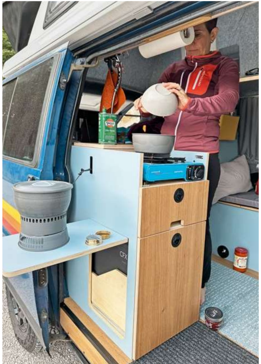
Bei gutem Wetter – Zweiflammkocher: Einmal Gas, einmal Spiritus. Für mehr Arbeitsfläche kann der Kocher samt Schublade herausgezogen werden.
