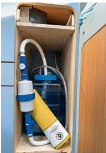
Reich-Wasserfilter und -Tandempumpe sorgen für eine zuverlässige Frischwasserversorgung.
