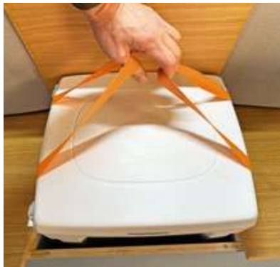
Auch wenn das Dachbett gebaut ist, kann man noch sitzen. Die Wanda-TTT wurde mit Gurten und vier Nieten auf Einhandbedienung umgebaut. Lieblingsplatz, wenn kalt: Vor dem Ausströmer der Eberspächer-Standheizung.
