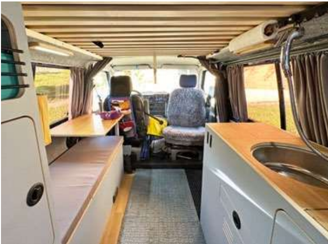
Auch wenn das Dachbett gebaut ist, kann man noch sitzen. Die Wanda-TTT wurde mit Gurten und vier Nieten auf Einhandbedienung umgebaut. Lieblingsplatz, wenn kalt: Vor dem Ausströmer der Eberspächer-Standheizung.
