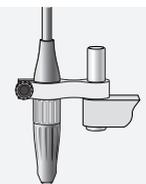
**Fräsgeräte-Adapter zum Einspannen des Schnellläuferhandstücks LA-9 in Fräsgeräte mit 16 oder 18 mm Durchmesser LA-9**
