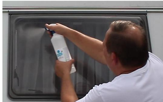
Direkt nach der Fahrzeugwäsche wird die Sprüh-Versiegelung auf das noch nasse Fahrzeug aufgesprüht, herunterlaufendes Wasser aus Sicken und Rillen muss vor der Versiegelung nicht getrocknet werden. Im Gegenteil: Die nasse Oberfläche unterstützt die Verteilung der Versiegelungs-Wirkstoffe auf der Fahrzeug-Außenhaut.
