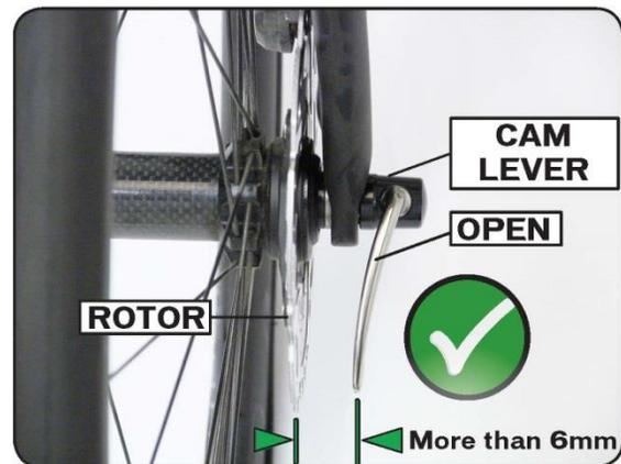
Figura 1. Alavanca de quick-release com potencial de contato      Figura 2. Alavanca de quick-release com abertura
