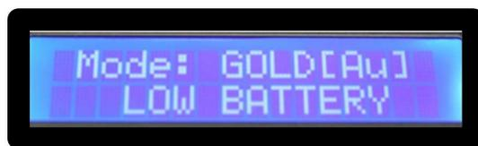
En este punto, el usuario debe detener la detección. Por último, cuando llega a 2,7 voltios, el detector se apaga. Los intervalos entre estos eventos dependen de la temperatura y la detección o no de objetivos. Retire
