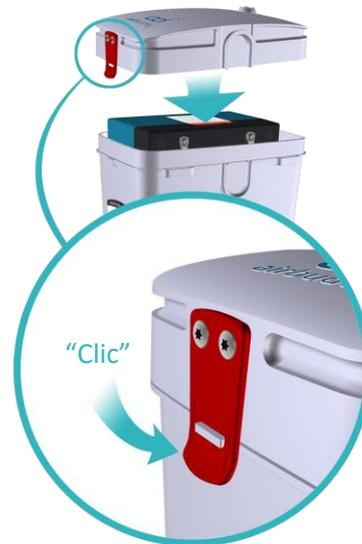
Coloque la manija de compresión nuevamente en la tapa estirándola sobre los puntos de unión en cada lado del AirBuddy.
