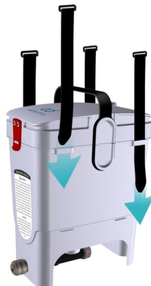
Coloque la unidad del compresor de aire de AirBuddy (con las correas de velcro) desde la parte superior hacia dentro del depósito de aire.
