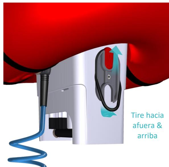
Espere unos 40 segundos hasta que el sistema se presurice completamente. Mire bajo el agua y verifique el manómetro del cual la presión haya alcanzado aproximadamente 2,6 bar (38 psi). Esta es la presión máxima del sistema. El exceso de presión se libera a través de una válvula interna de sobrepresión.
