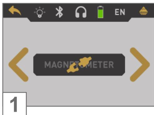
Encienda el aparato y seleccione "Magnetómetro" en el menú principal. Si no hay ninguna sonda adecuada conectada, el botón se desactiva y muestra el icono .
