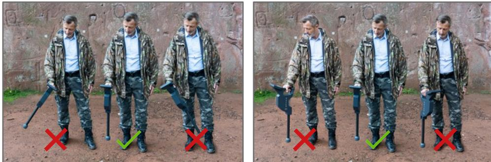
En cuanto suena una señal acústica, el aparato ha detectado un posible objeto metálico justo antes de la posición de la sonda. De este modo es posible encontrar pequeños objetos metálicos cerca de la superficie, como clavos, tornillos, cables, juntas y objetivos similares.
