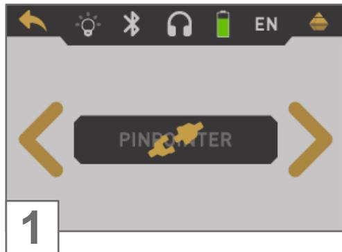
1 Encienda el aparato y seleccione el modo de funcionamiento "Pinpointer" en el menú principal. Si no hay ningún Super Sensor conectado, el botón se desactiva y muestra el icono .
