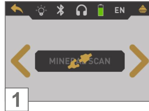
Encienda el dispositivo y seleccione "Mineral Scan". Si no hay ningún Súper Sensor conectado, el botón se desactiva y muestra el icono .
