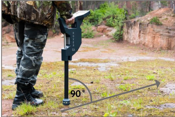
Muévase lentamente hacia delante, hacia atrás y hacia los lados, pero evite girar la sonda. La sonda debe apuntar siempre vertical al suelo. NO pivote, oscile ni gire alrededor de su propio eje.
