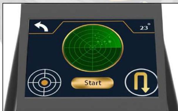
Apunte el dispositivo hacia el objetivo manteniendo el equilibrio del dispositivo, pulse el botón de inicio, espere hasta que oiga un pitido del dispositivo, entonces camine hacia el objetivo hasta que el dispositivo gire hacia atrás con la aparición de un icono que indica la rotación del dispositivo hacia atrás.
