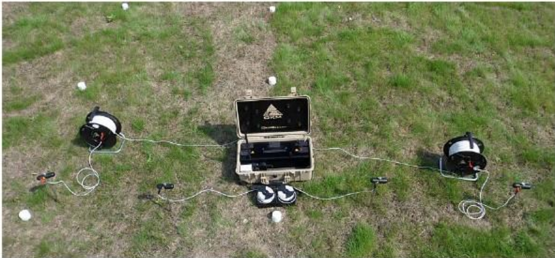
Figura 7.6: Disposición de los electrodos durante la exploración activa (exacto)
