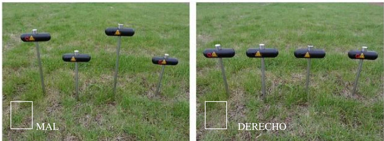
Figura 9.2: Los electrodos deben ajustarse por igual en la tierra
