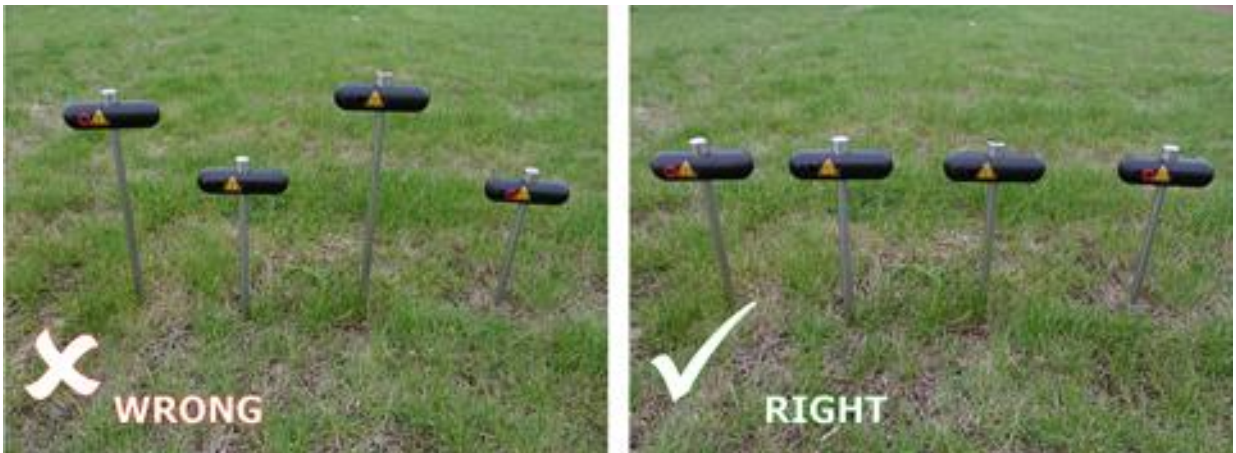
رسم رقم 9.2 : يجب أن تكون الأقطاب كلها على عمق متساوي في الأرض
