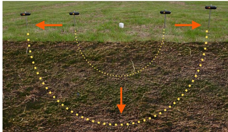
رسم رقم 7.3 : عمق حقنة الطاقة يعتمد على مسافة الأقطاب
