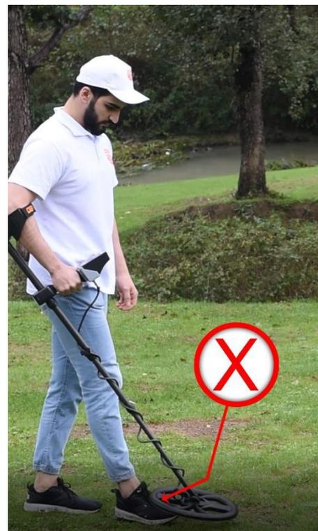
Evite el contacto excesivo con el suelo.
