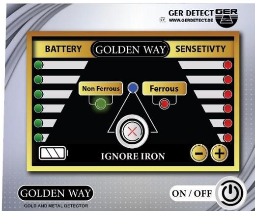
**FERROSO:** Si la señal indica que no es un metal no precioso, el dispositivo emitirá un tono diferente y se encenderá el indicador rojo.
