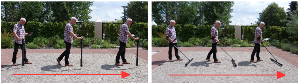
Figura 6.5: Escaneo del terreno en modo vertical y horizontal
