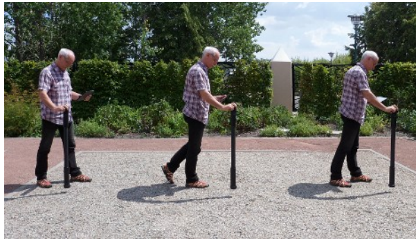
Figura 6.2: La sonda debe apuntar siempre hacia abajo y no debe girarse
