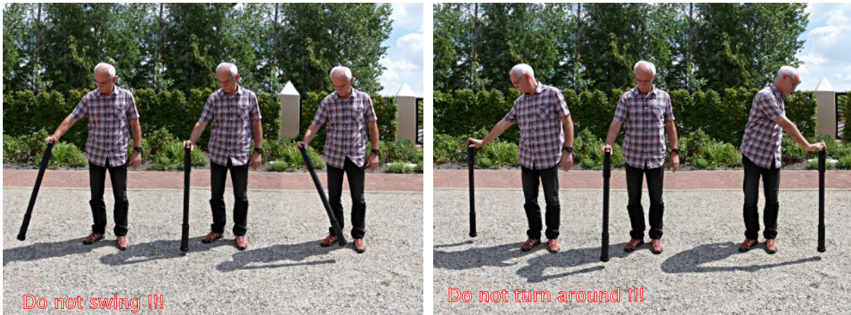
Figura 6.3: El giro de la sonda falsea la medición
