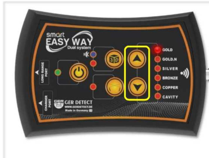
Después de seleccionar el objetivo que desea buscar, sujete firmemente la unidad principal en su cintura y entonces agarre el mango del sensor en un ángulo de **90 grados** para que la antena funcione correctamente.
