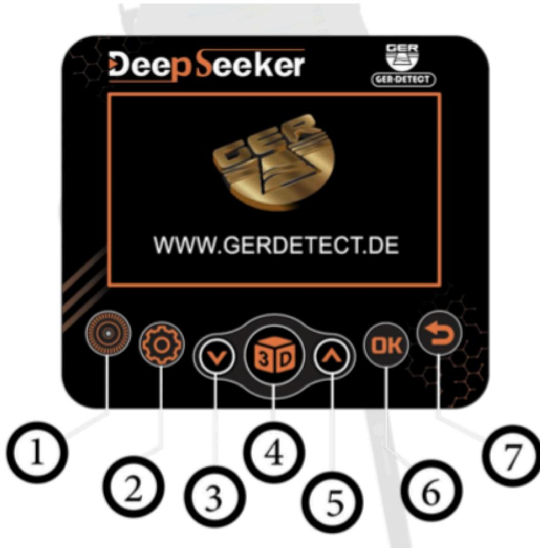
1. Botón de calibración: para calibrar el sistema iónico y magnetómetro.
