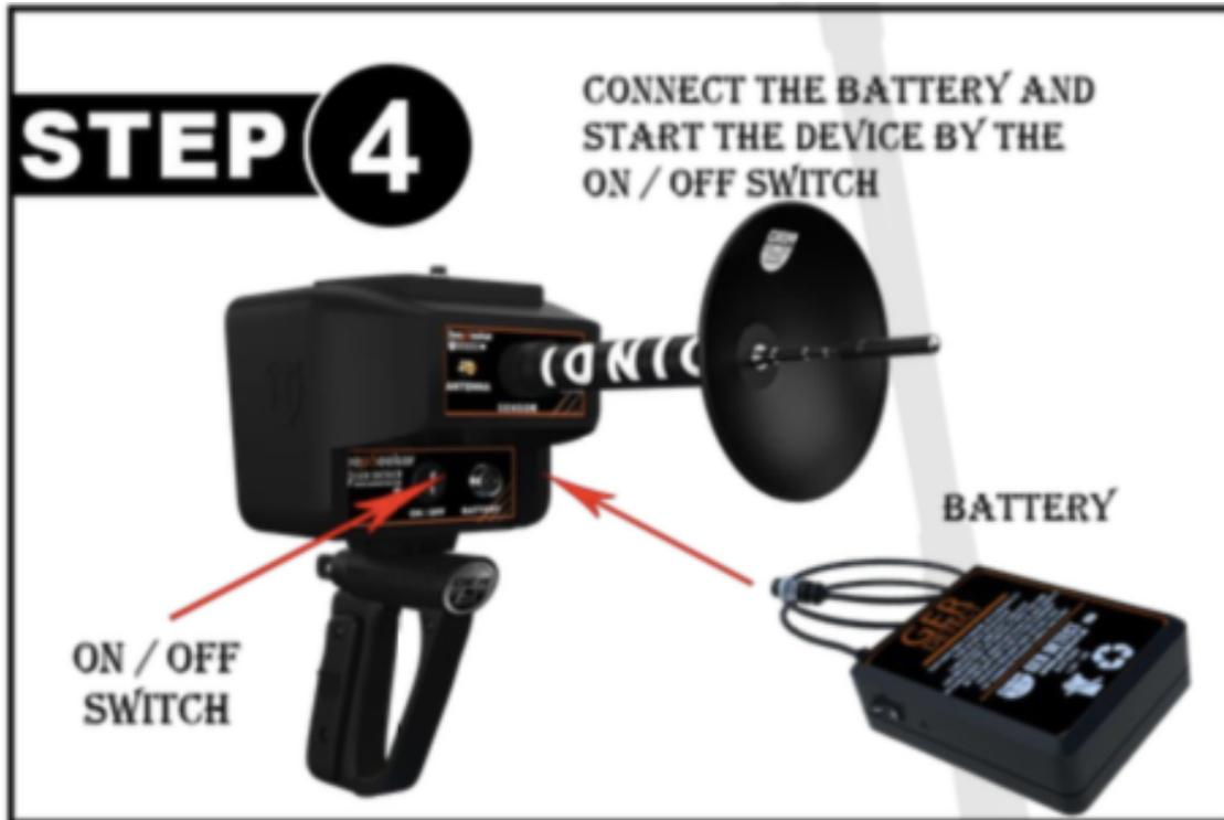
Paso 4 Conecte la batería y prenda el dispositivo presionando el botón de prendido/apagado
