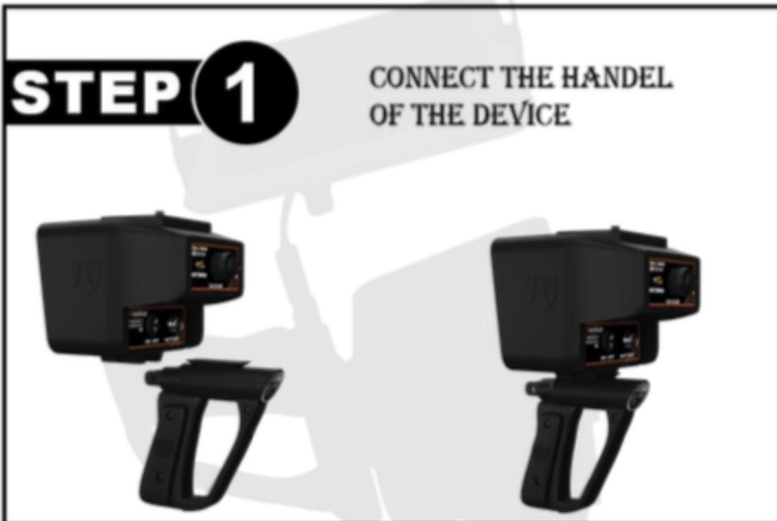
Paso 1 Conectar el mango del dispositivo
