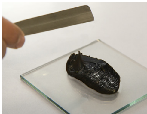
Consistentie ,kauwgumachtig', de afdichtingskit ,trekt zich terug' -> Pottijd is bereikt
