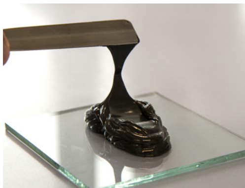
Consistentie pasteus, smeerbaar -> Pottijd is nog niet bereikt
