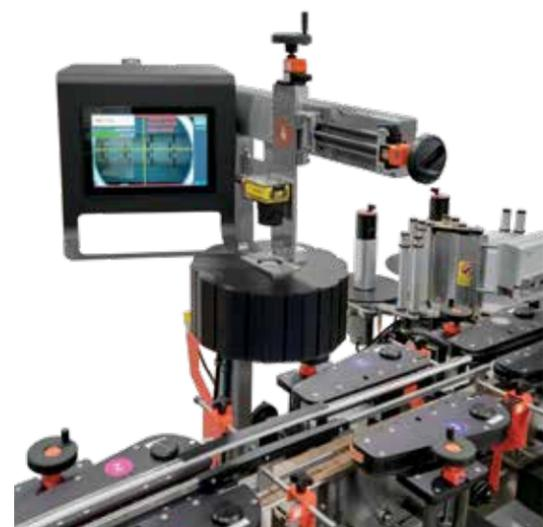
Des caméras ou capteurs de qualité professionnelle, combinés à un système de courroies servo-motorisées, font pivoter les contenants ronds et carrés. Ce système est offert en version intégrée à un puissant système d'étiquetage NITA ou en version autonome lorsque l'application d'étiquette n'est pas nécessaire.
