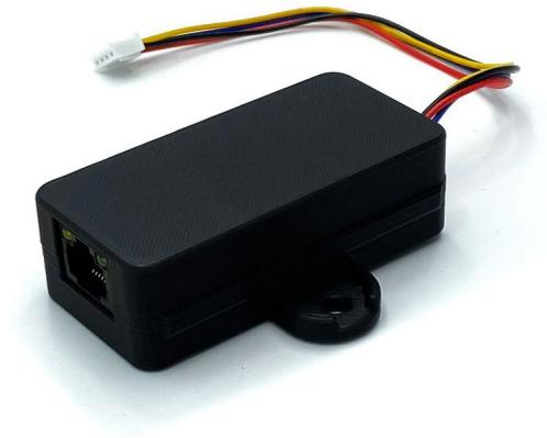
Wir stellen auf der VAN PI Hardware eine RJ45 Schnittstelle zur Verfügung auf welcher eine UART-Schnittstelle und VIN übertragen wird. Diese Schnittstelle kann zur Einbindung weiterer Hardware, wie zum Beispiel Nextion Displays und GPS genutzt werden. Die Versorgungsspannung wird auf 5V im Adapter geregelt und kann direkt genutzt werden.
