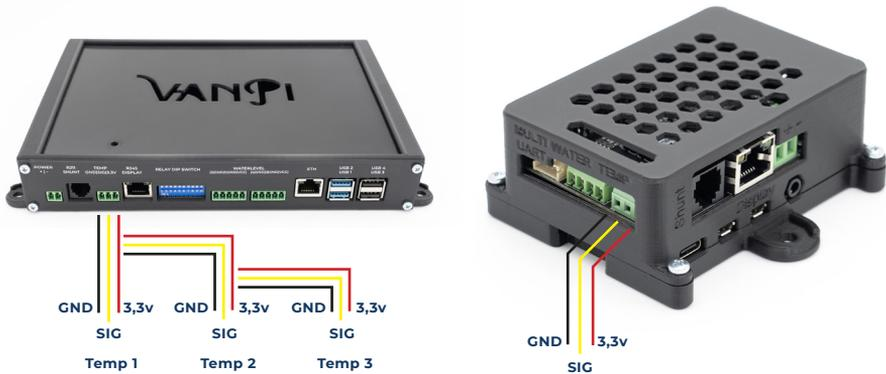
(Parallelschaltung mehrere Temperatursensoren)
