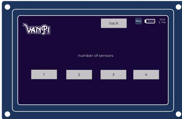
Wichtig bei der Belegung ist, dass du bei #1 anfängst, falls es weniger als 4 Sensoren sein sollten, da das Programm immer bei #1 anfängt zu zählen. Das bedeutet solltest du nur 2 Sensoren haben und z.B. den 1. auf der #2 und den 2. auf #4 - lässt dir aber nur 2 Sensoren anzeigen - wirst du lediglich Sensor Nummer 2 sehen.
