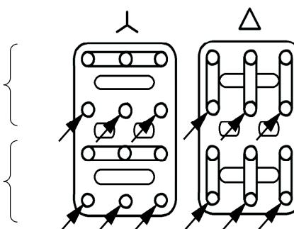
**Collegamento per motori a 2 velocità, 2 avvolgimenti separati, 6 morsetti**
