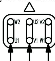
**Collegamento per motori a 2 velocità, unico avvolgimento**
