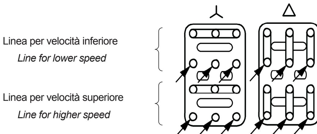
**Collegamento per motori a 2 velocità, 2 avvolgimenti separati, 6 morsetti**
