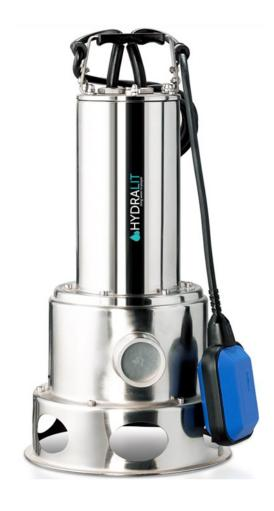
Elettropompa con girante tipo vortex in acciaio inox per movimentazione acque cariche con corpi solidi in sospensione, sollevamento di acque luride, svuotamento di fosse biologiche, travasi. Ideale per applicazioni domestiche, civili ed industriali. Prevalenze massime di 16 metri e portate di 400 l/min. Immersione massima 7 metri.
