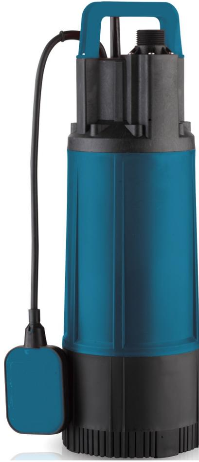
Elettropompe sommergibili multigrante con corpo pompa e giranti in plastica. In grado di sviluppare una portata massima pari a 100 l/min ed una ottima prevalenza fino a 40 metri. Queste elettropompe sono ideali per il pompaggio di acque pulite per l'approvvigionamento domestico da pozzi, vasche di raccolta o serbatoi. Ottimo anche per sistemi di irrigazione domestica o per svuotamento di cisterne.
