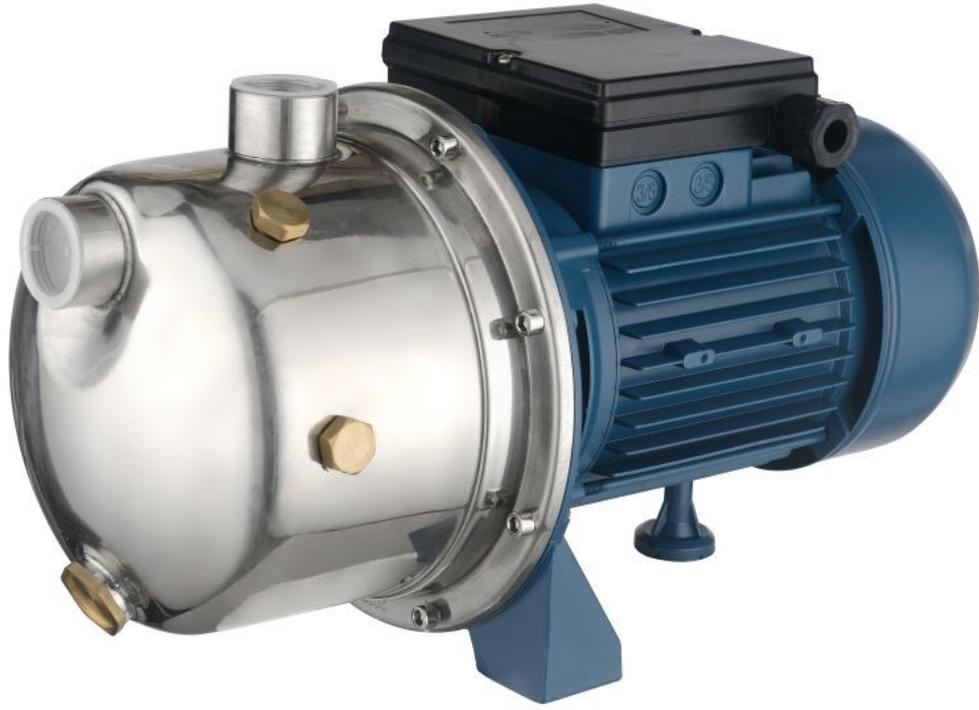
Elettropompe monoblocco autoadescanti tipo "JET" con gruppo eiettore incorporato. Questa serie di elettropompe permette l'aspirazione fino a 9 metri di profondità di acqua anche in presenza di aria. HYDRAJET garantisce un'ottima resa idraulica, una notevole capacità di aspirazione e di pressione, oltre ad una buona silenziosità. Si consiglia sempre l'utilizzo con liquidi chimicamente e meccanicamente puliti, e comunque con temperature mai superiori a +60°C.
