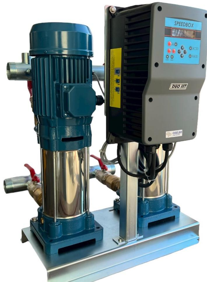
Sistema di pressurizzazione integrato composto da due elettropompe multistadio verticali ed un inverter. Soluzione ideale per la pressurizzazione nelle abitazioni, in ville e condomini dove si necessita di pressione costante e di buone portate. Ottimo anche per applicazioni in ambito civile ed industriale.
