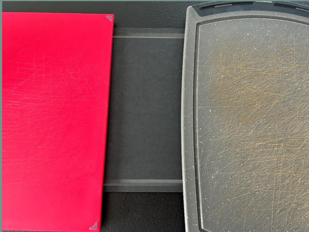
Die tiefe des Schnittes lässt darauf schließen, dass sich das pro planche zwar abnutzt, dies aber etwas länger dauert als bei Schneidebrettern aus Kunststoff. Wir werden bei neuen Erkenntnissen hier den Test ergänzen und ein Langzeit-Ergebnis ergänzen.
