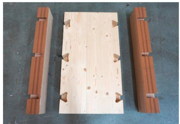
Abbildung 8 zur Reibungsminimierung abgeklebte und mit PTFE-Spray behandelte Kontaktflächen
