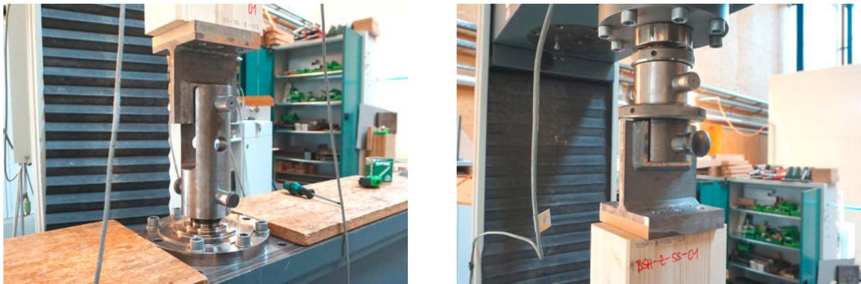
Abbildung 3 Lagerung und Lasteinleitung der Prüfkonfigurationen Zug BSH bzw. Zug BB
