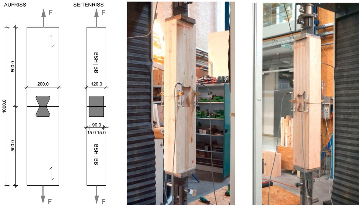
Abbildung 2 Übersicht der Prüfkonfiguration Zug BSH bzw. Zug BB (Maße in [mm])
