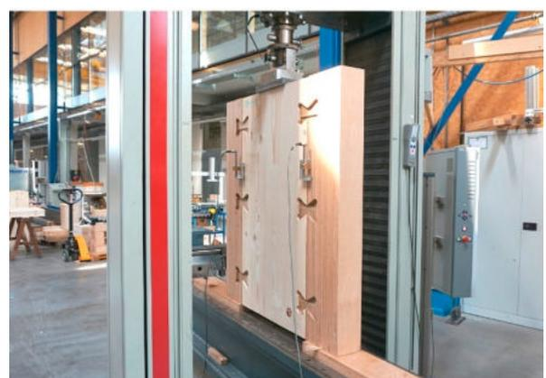
Abbildung 5 Übersicht Prüfkongfiguration Schub BSH-BSP bzw. Schub BB-BSP (Maße in [mm])
