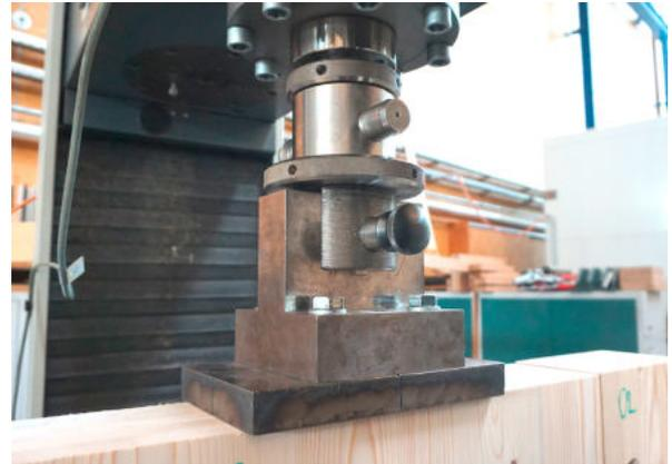
Abbildung 6 Lagerung und Lasteinleitung der Prüfkfigurationen Schub BSH-BSP bzw. Schub BB-BSP
