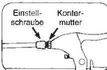
Nachstellen der Bremsen ist bei mechanischen Bremsen meist mit einer Einstellschraube am Griff möglich. Drehen Sie die Einstellschraube soweit aus dem Griff, dass ein sicheres Bremsen möglich ist. Sichern Sie diese Position durch Feststellen der Kontermutter am Griff.
