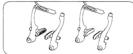
Falls ein Bremsgummi an der Felge schleift: Durch die Federeinstellschrauben können Sie die Rückfederkraft so einstellen, dass sich beide Bremsgummis gleichmäßig von der Felge abheben, wenn Sie den Bremshebel loslassen. Anschließend überprüfen Sie die korrekte Funktion der Bremse.
