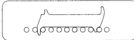
Wenn eine Kette so verschlissen wie diese ist, sinkt das Messwerkzeug komplett ein. Diese Kette muss ausgewechselt werden.
