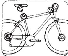
Mögliche Positionen von Schnellspannern, Steckachsen und Verschraubungen
