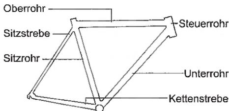
Je nach Typ und Funktion des Rades unterscheiden sich die Rahmenformen. Moderne Rahmen bestehen aus unterschiedlichen Materialien, wie beispielsweise Stahl- oder Aluminiumlegierungen oder Carbon (Kohlefaser).
