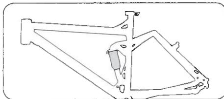
Hier ist der Hinterbau des Rahmens beweglich gelagert und mit einem Stoßdämpfer gefedert und gedämpft.
