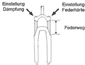
Die Abstimmung einer Federgabel muss nach Bedienungsanleitung des Gabelherstellers erfolgen. Generell gilt, dass die Gabel beim Überfahren von Unebenheiten merklich arbeiten, aber nicht „durchschlagen“, also bis auf Anschlag einfedern sollte. Bei einer passenden Grundeinstellung wird das Federelement etwa 10 – 15 % des Federwegs zusammengedrückt, wenn der Fahrer ruhig auf dem Rad sitzt.
