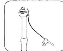
Teleskopsattelstütze mit Fernbedienung
