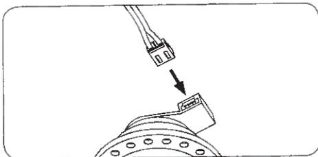
Zum Einbau des Lampenkabels muss die Anschlussklemme des Nabendynamos in Fahrtrichtung rechts montiert sein. Verbinden Sie die Stecker wieder korrekt miteinander und überprüfen Sie die Funktion der Beleuchtung. Drehen Sie hierfür das Vorderrad und kontrollieren Sie, ob die Leuchte aufleuchtet.
