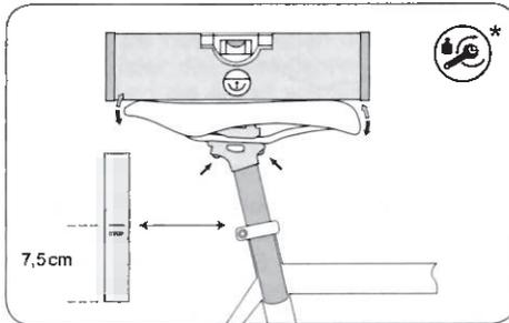
Patentstütze mit Zweischraubenbefestigung
