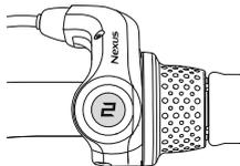
(A) śruba regulacji napięcia linki
