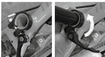
De foto's aan de linkerkant tonen het sluiten van een snelspanner voor het klemmen van het zadel.
