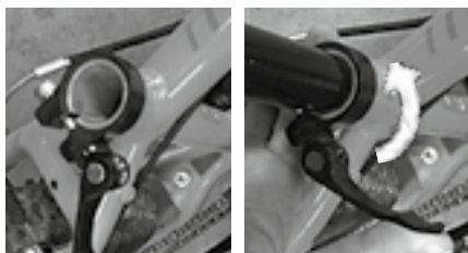
Les images à gauche montrent comment fermer le serrage rapide pour fixer la selle.
