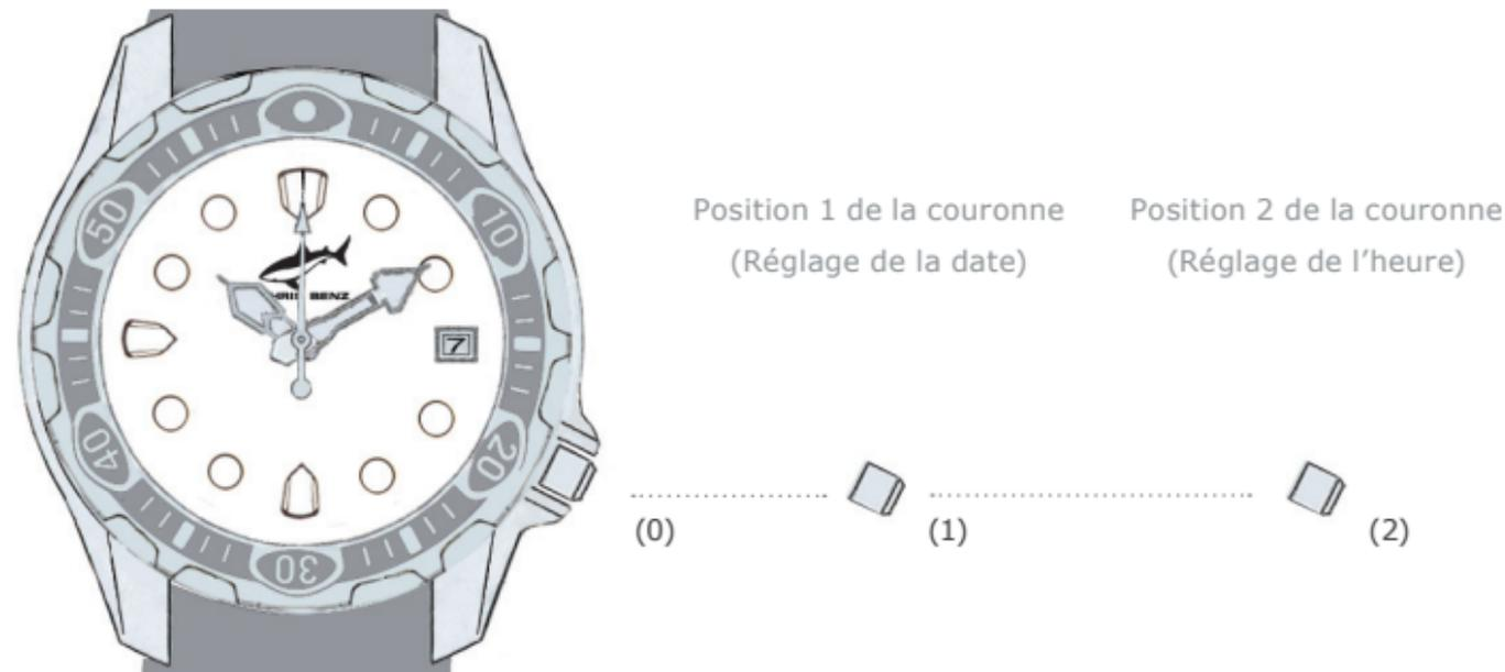
La couronne de votre CHRIS BENZ DEEP 500M Automatic est vissée et doit seulement être dévissée pour faire des réglages. Veuillez ne pas manipuler la couronne dans l'eau ou lorsque la montre est mouillée. L'étanchéité est garantie que si la couronne est parfaitement vissée.
