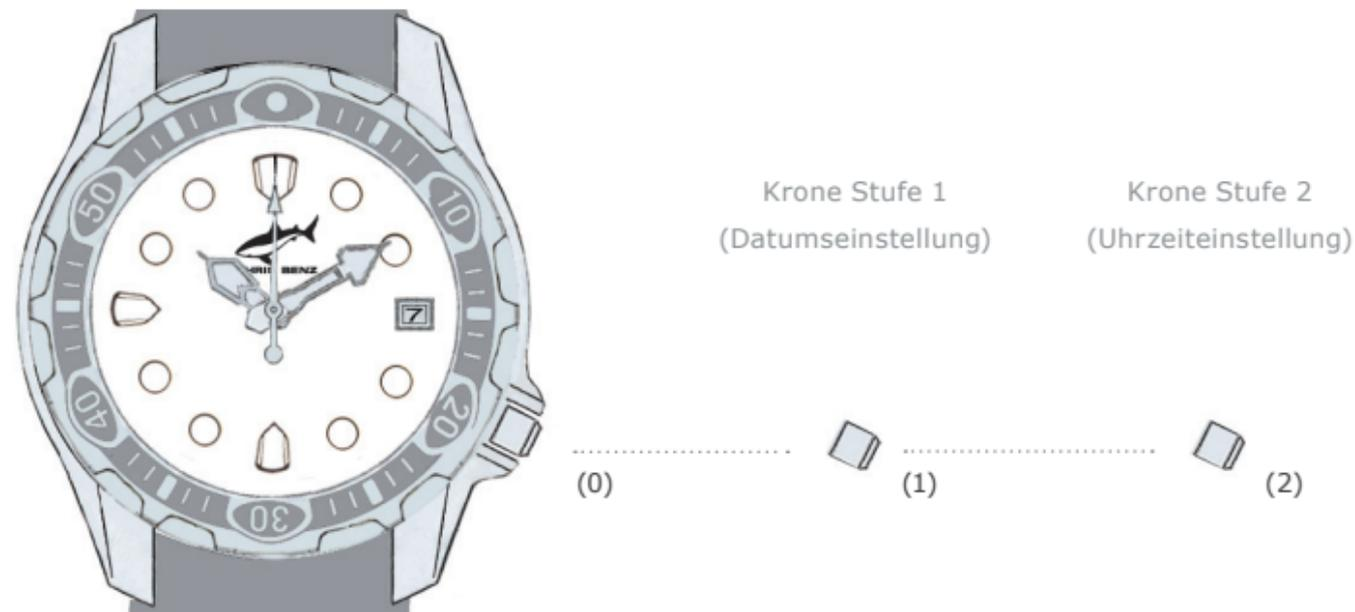
Die Krone der CHRIS BENZ DEEP 500M Automatic Modelle ist verschraubt und muss erst gelöst werden, um Einstellungen vornehmen zu können! Bitte die Krone nicht im Wasser oder wenn die Uhr nass ist bedienen. Die Uhr ist nur wasserdicht, wenn die Krone verschraubt und somit richtig verschlossen ist.
