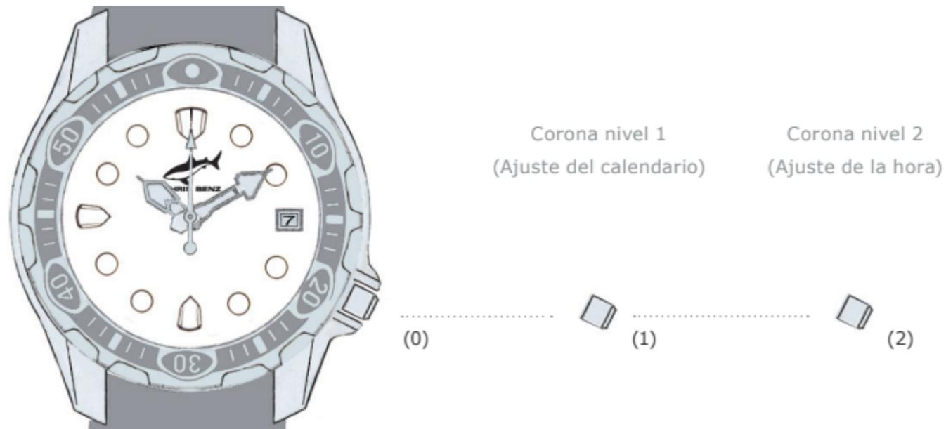
¡La corona de los modelo CHRIS BENZ DEEP 500M AUTOMATIC está atornillada y tiene que ser aflojada, para poder realizar el ajuste! No opere la corona debajo del agua ni cuando el reloj esté húmedo. El reloj es impermeable solamente si la corona está enroscada y correctamente cerrada.
