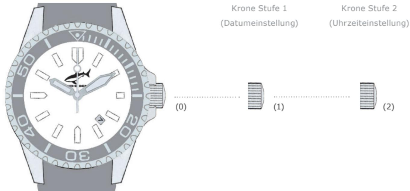
Die Krone des CHRIS BENZ DEEP 2000M Automatic Modells ist verschraubt und muss erst gelöst werden, um Einstellungen vornehmen zu können! Bitte die Krone nicht im Wasser oder wenn die Uhr nass ist bedienen. Die Uhr ist nur wasserdicht, wenn die Krone verschraubt und somit richtig verschlossen ist.
