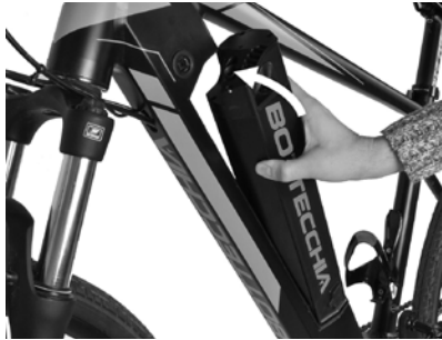
Instalación de la batería
