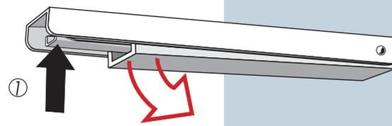
Durch Eindrücken des Rasterhebels ① löst sich die Arretierung und der Klappräger kann geöffnet werden.
