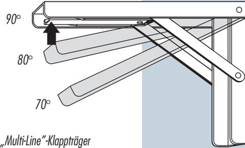
Der „Multi-Line“-Klappräger arretiert in drei Abstufungen: 90°, 80° und 70°. Zum Lösen der Arretierung muß jeweils der Rasterhebel ① gedrückt werden.
