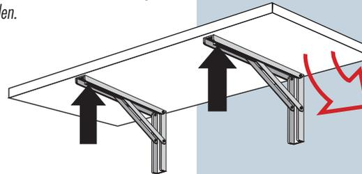
Zum Verstellen und Einklappen fertig montierter „Multi-line“-Klappräger müssen beide Rasterhebel gleichzeitig eingedrückt werden.
