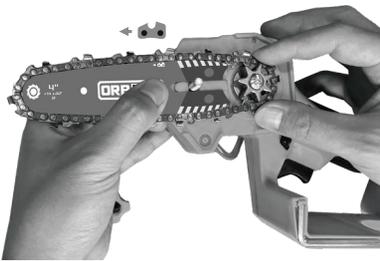
2. Instalar la placa guía y la cadena, asegurarse de que la placa de la cadena esté orientada correctamente.
