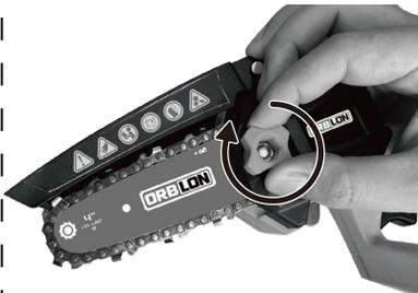
4. Levante el deflector de protección, coloque la cubierta y apriete la tuerca de fijación de la cubierta en sentido horario.
