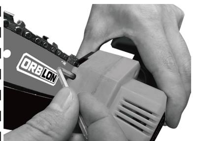
2. Gira el tornillo de la cubierta utilizando un destornillador en forma de L para ajustar la tensión de la cadena. Asegúrate de que solo haya aproximadamente 0,3 cm de espacio al tirar de la cadena. De lo contrario, la cadena puede caerse o causar que la máquina se atasque.
