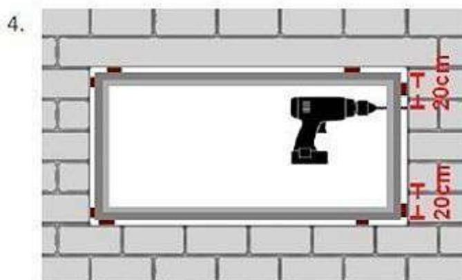
Bohren Sie alle Löcher mit einem passenden Bohrer vor. Bohren Sie dabei direkt vom Rahmen in die Mauer. Der Abstand zwischen zwei Schrauben sollte rundherum nicht mehr als 60 cm betragen. Je nach Größe müssen dementsprechend viele Schrauben montiert werden. Die Bohrungen rechts und links sollten in einem Abstand von ca. 20cm zu den Rahmenecken montiert werden.
