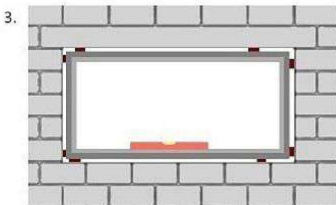
Bringen Sie den Fensterrahmen horizontal und vertikal, mit Hilfe der Montageklötze, in die Waage.
