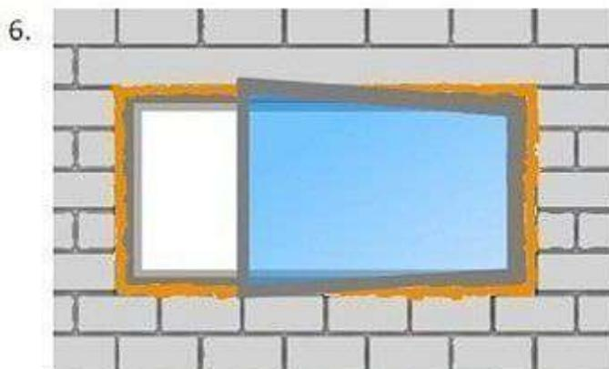
Setzen Sie den Fensterflügel am unteren Ende mit dem Scharnier in die Scharniere ein. Zum Schluss müssen Sie nur noch den Griff einsetzen.
