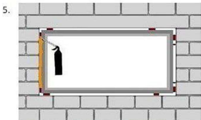
Entfernen Sie die Montagekeile und schäumen Sie den Zwischenraum zwischen Blendrahmen und Wand aus.
