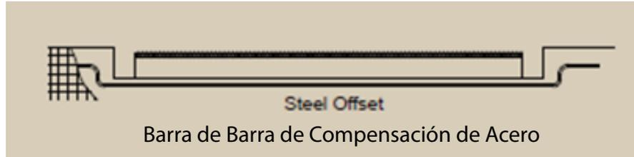
Figura 2: Ejemplo de Barra de Compensación de Acero
